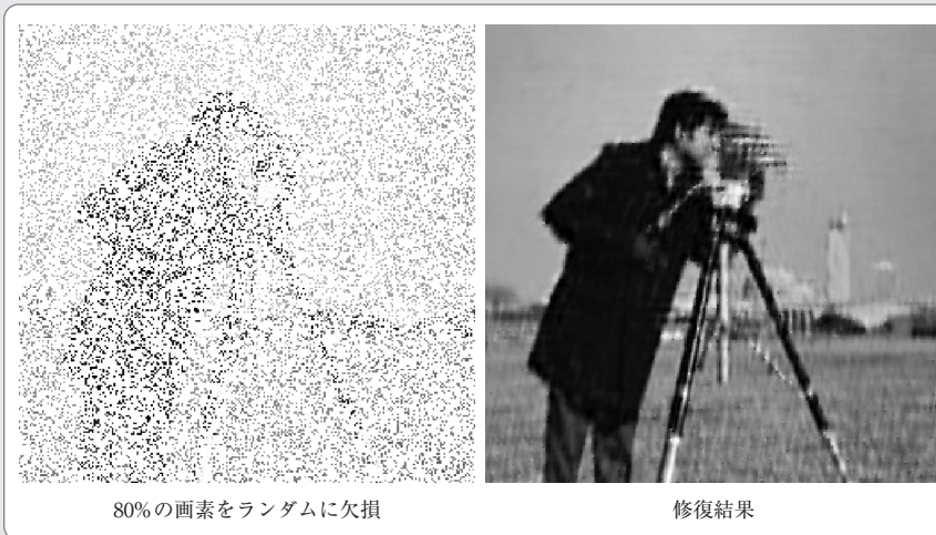
図2 ランダム欠損の修復例
