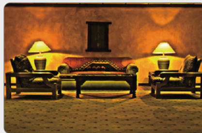
図6 トーンマッピング処理の一例 通常のトーンマッピングでは、輝度の低いテクスチャ部分と輝度が高い照明部分を圧縮率を変えながら8ビット階調空間に圧縮します。ただ、空間的な分布を考慮しないと輝度変化が激しい部分に人工的な偽像が発生することがあります。
