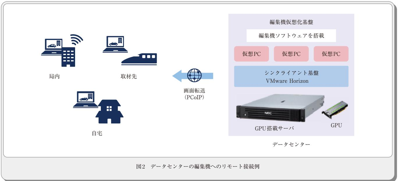
図2 データセンターの編集機へのリモート接続例
