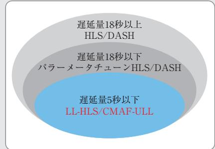
図3 HTTP Streaming プロトコル遅延量ターゲット
