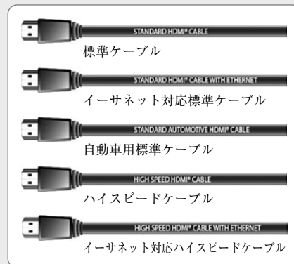
図4 5種類のHDMIケーブル 各ケーブルには種別が記載されている。
