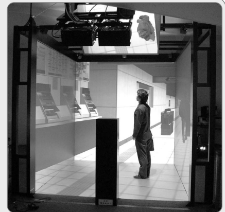
図6 CAVE型ディスプレイでの実寸大表示 (中央の人物はCGではありません)
