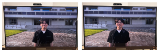
図6:受信側の自動立体視3Dで表示された立体視映像の両目の位置からキャプチャされたステレオ画像。
