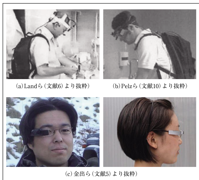
図3 単眼型のInside-Outカメラ
