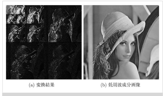
図5 離散ウェーブレット変換
