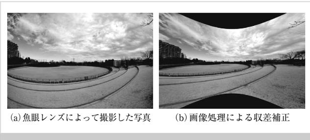
図9 画像処理による歪曲の補正
