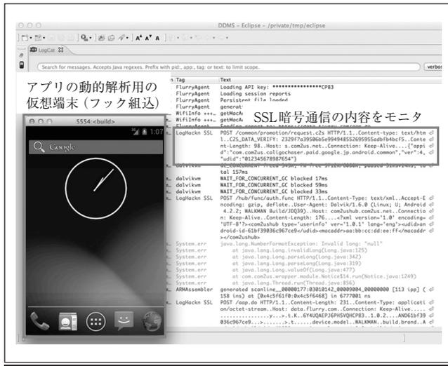
図6 アプリの動的解析用OSとSSL処理のフックの様子
