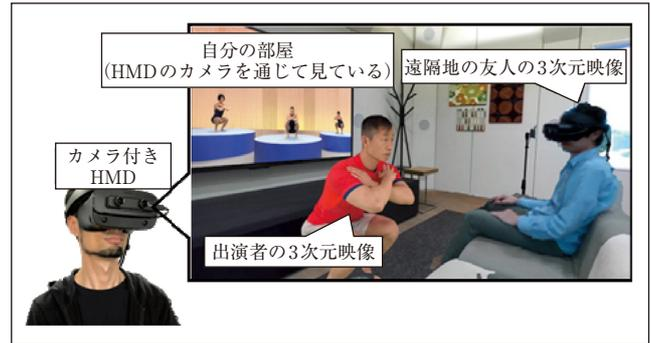
図3 空間共有コンテンツ視聴システムの利用シーン<sup>14)</sup>
