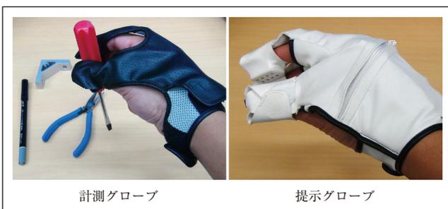
図3 触覚伝送グローブの使用例<sup>11)</sup>
