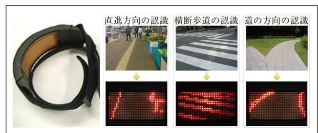
図6 オーデコ<sup>18) 19)</sup>の電極部(左)と電気刺激により提示される刺激のイメージ(右)
