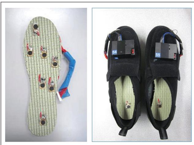
図5 スマートインソール(左)と使用例(右)<sup>16) 17)</sup>
