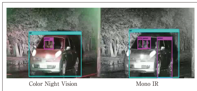
図5 画像認識ソフトウェア実行時の様子 カラー暗視映像では、車と人の切り出しが正確にできている。
