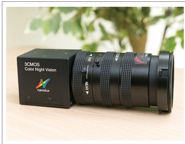
図4 ナノルクスが発売するカラー暗視カメラ レンズは付属しないが、赤外線投光器を同梱する予定。内蔵するCMOSセンサは1/1.8型の「IMX265」。
